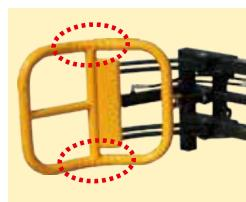
凹凸加工されたハンド部は、人間の指の形状や、滑りにくいように凹凸加工を施した箸の先のように、食い込みが良くしっかりとベールをつかむことができます。
