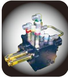
LS回路が内蔵されたトラクタには、**ローダ専用高性能LSバルブ**を搭載しました。1本の操作レバーだけで、ロールサイレージや野菜コンテナなどの重量物も「ジュワー」とゆっくりとした速度で「オペレータが意図する速度でコントロールできます。まぎらわしい操作やよけいな神経をつかうことなく安心して作業をすることができます。また、**定比分配機能を内蔵することにより、4本の各シリンダにバランスよく油圧力を発揮させることができ「スクイながら上昇」などの同時操作が断然パワフル**に行えます。
