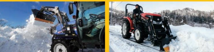
除雪作業は、トラクタの前方で作業ができるので見やすく、疲れにくく、排雪や重い雪の高所への積み上げもスピーディーに余裕ある作業が行えます。
