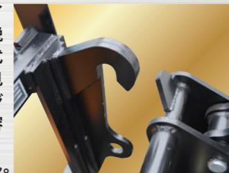
頻繁に行うアタッチの交換も、左右連結のクイックチェンジ方式で手間も力もかけず簡単に取り替えできます。
