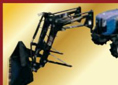
頻繁に行うアタッチの交換も、左右連結のクイックチェンジ方式で手間も力もかけず簡単に切り替えます。
