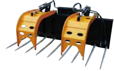
ベールフォーク ロールベールの 運搬積み込み用 タイン長990、1250mm タイン間隔600、800mm で使用可能
