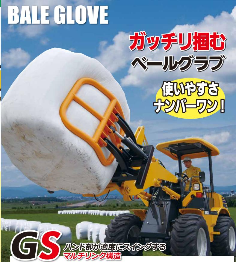
ハンド部が適度にスイングする「GSマルチリンク構造」は、いびつな形状のベールでもガッチリと掴むことができます。また、並べたベールを抜き取るときもとってもスムーズに抜き取ることができます。
