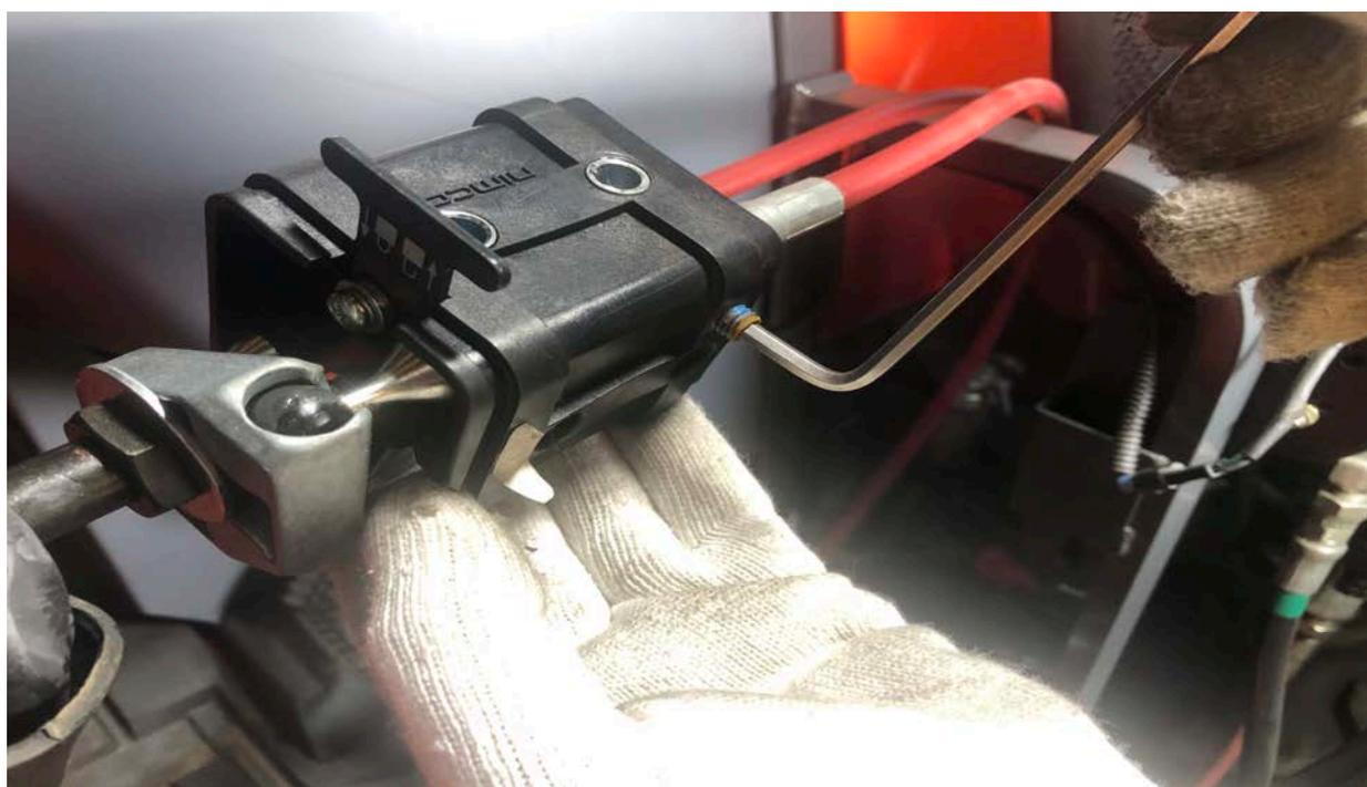
4、操作レバーボックスの側面にあるホーローセットを外す
