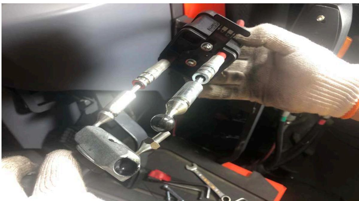
6、ワイヤー先端（丸いボール部）をレバーリンクより横にずらし抜く
