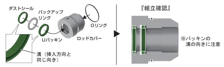
② ピストンにUパッキン・バックアップリングを取り付ける。
